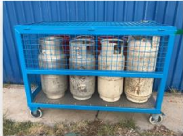
Ilustración 5.1: Racks para tanques de gas.
